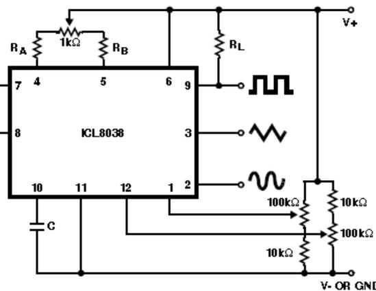
图 4 最小正弦波失真连接框图
