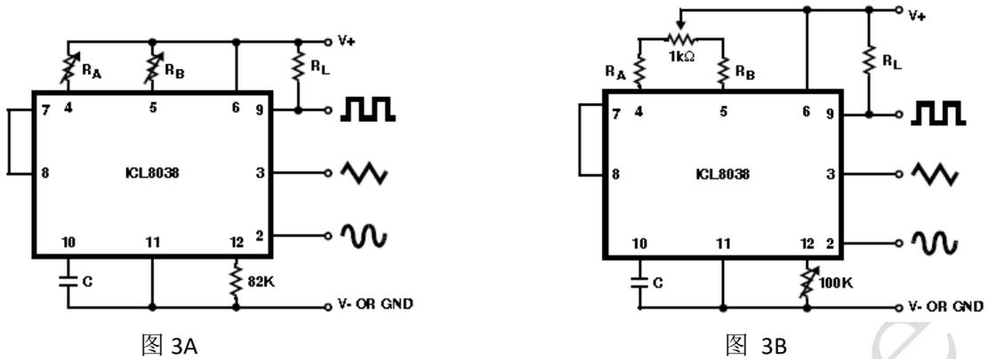
图 3 外部时序电阻连接图
