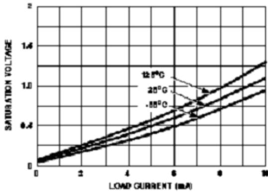
图15. 方波饱和电压和负载电流
