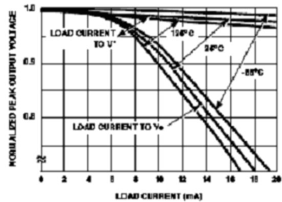
图16. 三角波输出电压和负载电流
