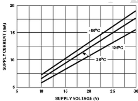
图11. 电源电流和电源电压
