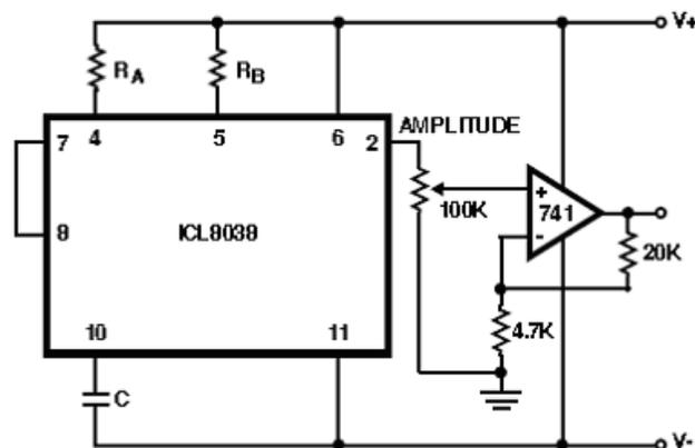
图6. 正弦波输出端缓冲放大器
